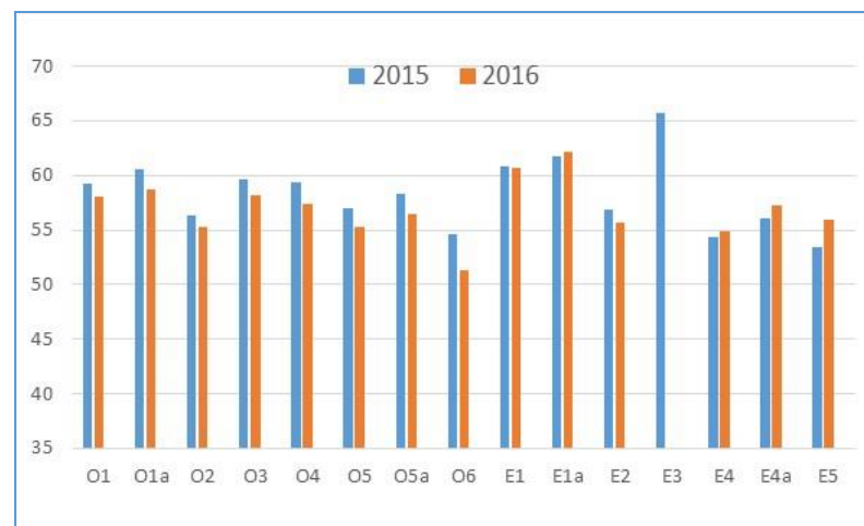
Fig. 2 - Résultats projetés sur 24 heures ( L_{Aeq,24h} ) pour chaque site de mesure, secteur 122 e Rue (données du MTQ, 2015 et 2016).
